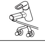
小型電気温水器(即湯器)等に給湯ホースを接続する際は、ステンレスフレキ管等を介してください。
