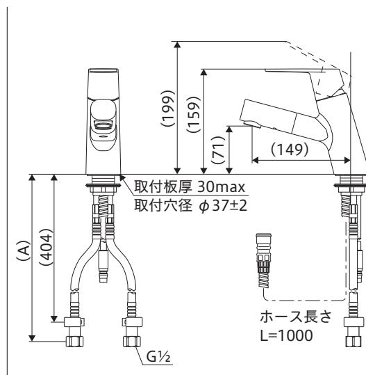
A寸法: 逆止弁付 435 / 逆止弁無し 423
