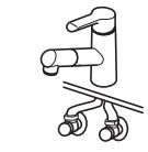
**小型電気温水器(即湯器)等に給湯ホースを接続する際は、ステンフレキ管等を介してください。**
