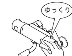
急に閉めると「ドン」という音がして配管に衝撃が加わり漏水で家財などを濡らす財産損害発生のおそれがあります。
