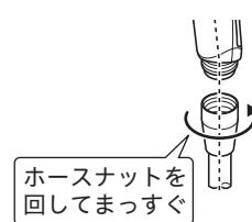
ヘッドのねじ部は樹脂製のため、斜めに取り付けるとねじがつぶれ、ホースに取り付けできなくなる場合があります。
