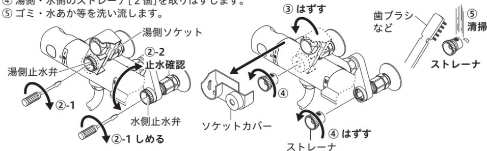
清掃後は、はずした逆の手順で組み込んでください。ストレーナを締め込む時は、吐水切替ハンドルを吐水口側にしてください。
