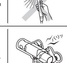
凍結が予想される際は、一般地仕様をお使いの場合は少量の水を出していくか配管に布を巻くなどして凍結を防止してください。寒冷地仕様をお使いの場合は配管の水抜き操作と水栓金具の水抜き操作を行ってください。
