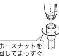
ヘッドのねじ部は樹脂製のため、斜めに取り付けるとねじがつぶれ、ホースに取り付けできなくなる場合があります。
