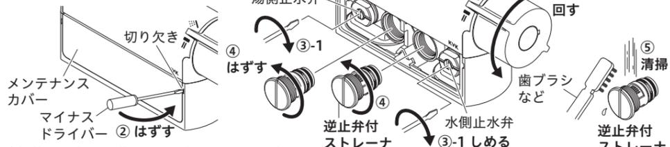
清掃後は、上記の逆の手順で組み込んでください。シャワー仕様の場合、逆止弁付ストレーナを締め込むとき、吐水切替ハンドルを吐水側にしてください。混合栓仕様の場合、逆止弁付ストレーナを締め込むとき、吐水ハンドルを吐水側にしてください。
