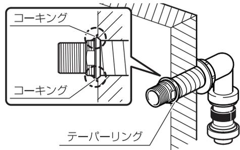
(7) 共回りを防ぐため2面部分を工具でおさえ、配管を接続する。
