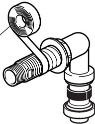
(4) 壁面に媒介エルボを取付け、テーパーリングを2面部分より奥までねじ込み、仮止めする。
