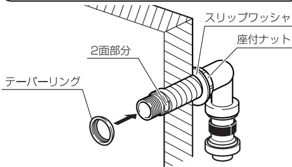
(5) 座付ナットを締付け、壁面に固定する。
