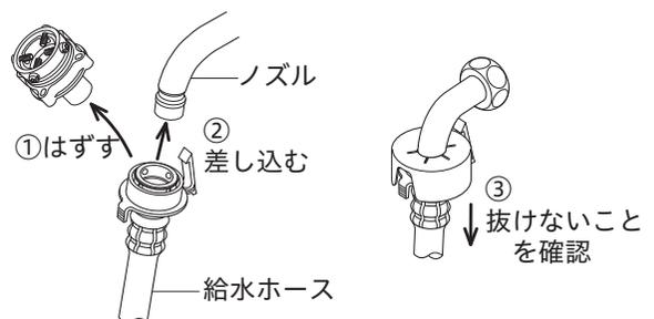
取り付け後に必ず、水を通して漏れがないことを確認してください。
