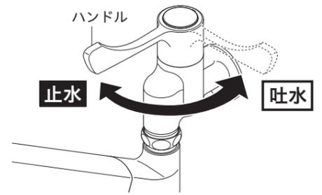
【△注意】ハンドルは無理な力を加えずゆっくり操作してください。急な操作や無理な力での操作はウォーターハンマー(水撃)音が発生し、配管からの漏水により家財などを濡らす財産損害発生のおそれがあります。
