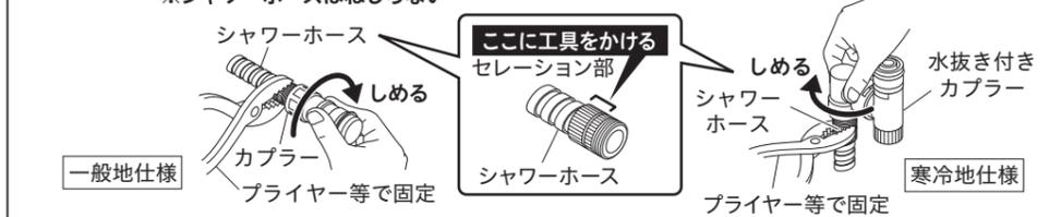
② カプラーのキャップをはずし、スライダーを下に下ろしてからプラグへカチッと音がするまではめ込みます。(寒冷地仕様の場合はエルボが下向きになっていることを確認します。)取り付け後、カプラー(寒冷地仕様は水抜き付きカプラー)を引っぱってはずれないことを確認します。
