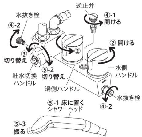
シャワー仕様 (本体に逆止弁と水抜き栓がない場合)
