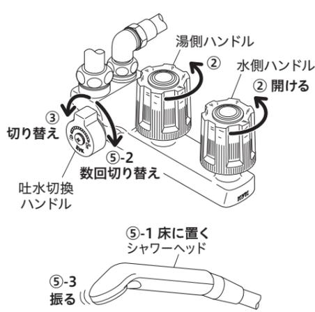
水抜き後 通水を再開する
