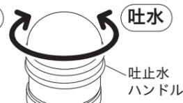
【通水音が大きい場合】吐水ハンドルを使用する際に通水音が大きい場合は、湯水の止水弁をしぼって吐水ハンドルを全開にして使用してください。(流量の調節方法参照)
