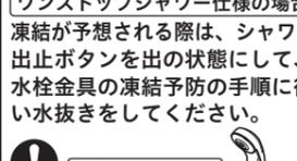
水抜きしないと凍結破損で漏水し、家財などを濡らす財産損害発生のおそれがあります。
