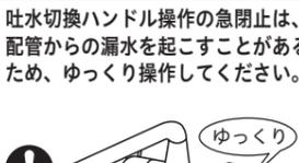
急に閉めると「ドン」という音がして配管に衝撃が加わり漏水で家財などを濡らす財産損害発生のおそれがあります。
