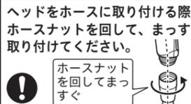
ヘッドのねじ部は樹脂製のため、斜めに取り付けると、ねじがつぶれ、ホースに取り付けできなくなる場合があります。
