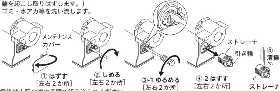
清掃後は上記の逆の手順で組み込んでください。ストレーナを締め込む時、吐水切換ハンドルを吐水口側にしてください。
