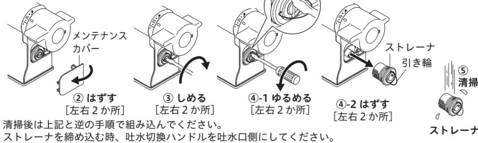
清掃後は上記と逆の手順で組み込んでください。ストレーナを締め込む時、吐水切換ハンドルを吐水口側にしてください。
