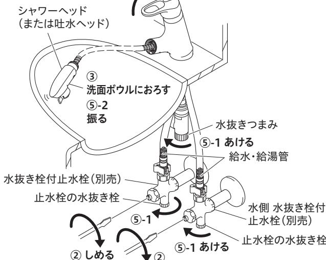
水抜き後 通水を再開する
