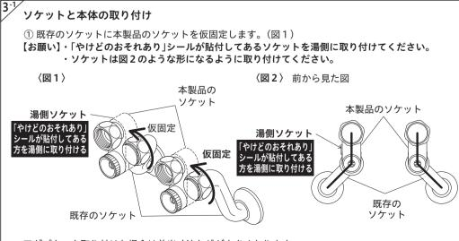
アダプターを取り付けた場合は前出寸法などが大きくなります。 既存のソケットの仕様によって、本製品のソケットと既存のソケットの間に取り付ける パッキンの大きさ、アダプターが異なります。〈表1〉を参照して取り付けてください。 [ \_\_\_\_\_ 注意] この時、古いパッキンを取りはずし、付属の新しいパッキンと必ず交換してください。 交換されていないと漏水するおそれがあります。
