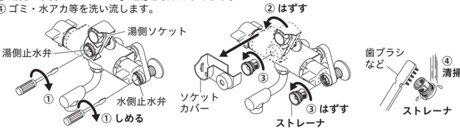
清掃後は上記の逆の手順で組み込んでください。ストレーナを締め込む時、吐水切換ハンドルを吐水口側にしてください。
