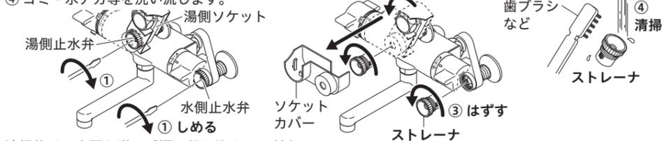
清掃後は、上記と逆の手順で組み込んでください。ストレーナを締め込む時、吐水切換ハンドルを吐水口側にしてください。
