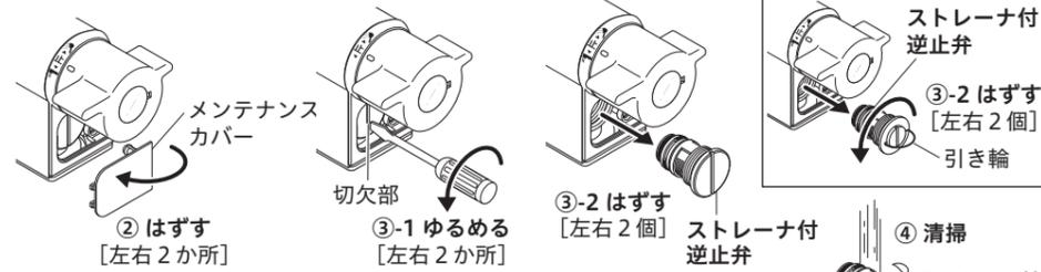
清掃後は上記の逆の手順で組み込んでください。ストレーナ付逆止弁を締め込む時、吐水切換ハンドルを吐水口側にしてください。
