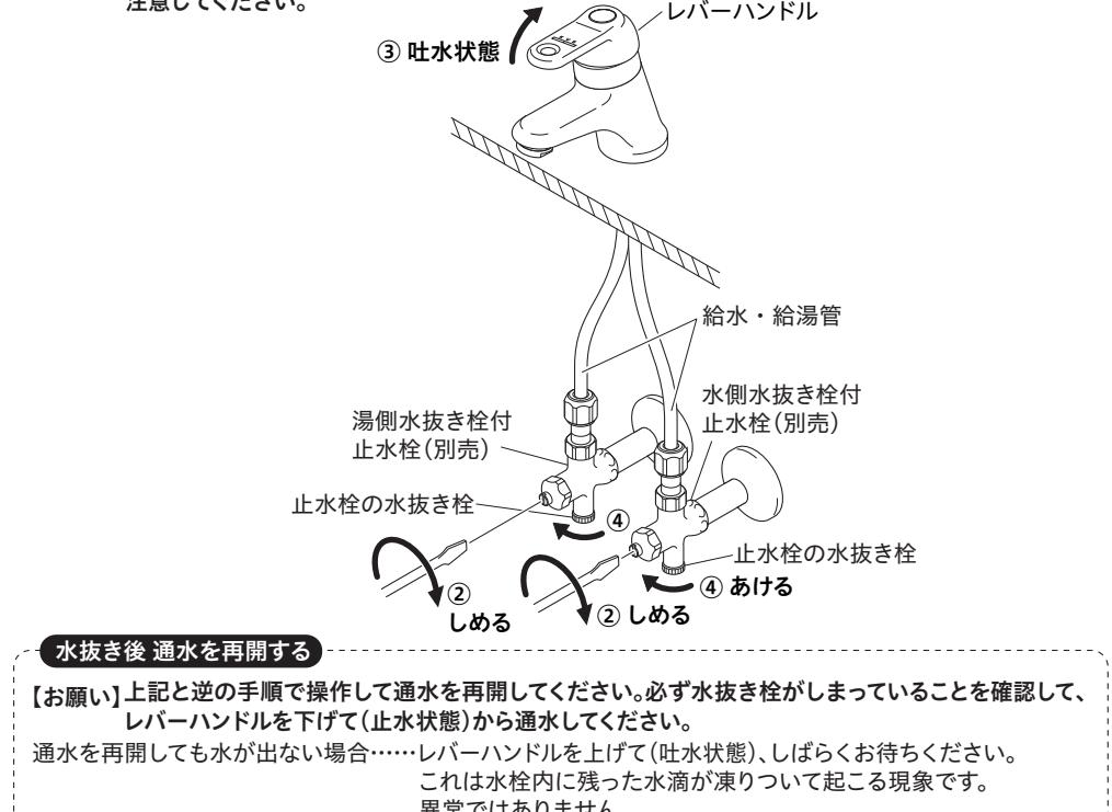
【お願い】上記と逆の手順で操作して通水を再開してください。必ず水抜き栓がしまっていることを確認して、レバーハンドルを下げて(止水状態)から通水してください。
