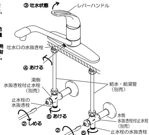
水抜き後 通水を再開する
