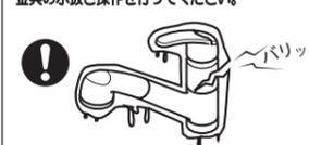
凍結破損で漏水し、家財などを濡らす財産損害発生のおそれがあります。配管などの解凍の為、解凍機をご使用の場合は水栓部には絶対に通電しないでください。
