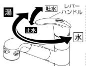
シャワー握りを左右にふる際のご注意 -----【 ∴ 注意】 シャワー握り回転方向に無理な力を加えないでください。器具が 破損し、けがをしたり、漏水し、家財などを濡らす財産損害発生
