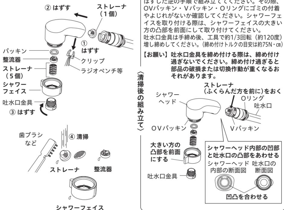
はずした逆の手順で組み立ててください。その際、OVパッキン・Vパッキン・Oリングにゴミの付着やよじれがないか確認してください。シャワーフェイスを取り付ける際は、シャワーフェイスの大きい方の凸部を前面にして取り付けてください。吐水口金具は手締め後、工具で約1/3回転(約120度)増し締めしてください。(締め付けトルクの目安は約75N・cm)
