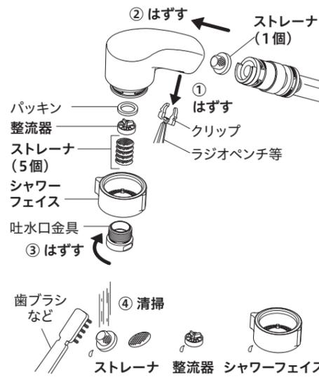
はずした逆の手順で組み立ててください。その際、OVパッキン・Vパッキン・Oリングにゴミの付着やよじれがないか確認してください。シャワーフェイスを取り付ける際は、シャワーフェイスの大きい方の凸部を前面にして取り付けてください。吐水口金具は手締め後、工具で約1/3回転(約120度)増し締めしてください。(締め付けトルクの目安は約75N・cm)
