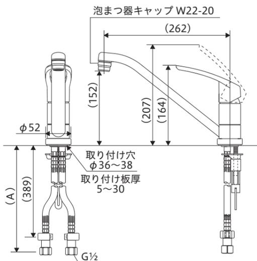
A部寸法: 逆止弁付き仕様 420 / 逆止弁なし仕様 408
