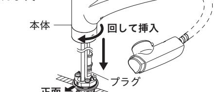
②-3 本体が正面を向くように、さらに回転させます。ねじ穴がある方が正面です。本体のねじ穴と、上面アダプターのねじ穴が合うように挿入します。
