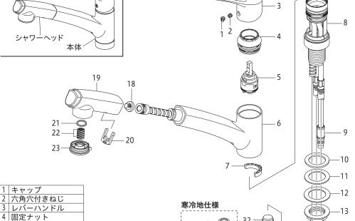
2 六角穴付きねじ 3 レバーハンドル 4 固定ナット 5 カートリッジ 6 吐水口 7 回転規制ストッパー 8 本体 9 プラグ 10 シートパッキン 11 輪パッキン 12 スリップ板 13 座付きナット 14 ホースガイドA <u>15 ホースガイドB</u> 16 カプラー 17 シャワーホース 18 ストレーナ 19 シャワーヘッド 20 クリップ 21 パッキン |22| ストレーナ 23 シャワーフェイス 24 ブレードホース 25 ジョイント 26 逆止弁 27 パッキン 31 ジョイント
