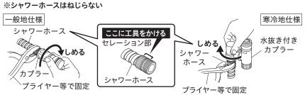
④ カプラーのキャップをはずし、スライダーを下に下ろしてから、本体のプラグへカチッと音がするまで押し 込みます。(スライダーがすでに下りている場合もあります。寒冷地仕様の場合はエルボが下向きになって いることを確認します。)
