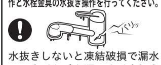
水抜きしないと凍結破損で漏水し、家財などを濡らす財産損害発生のおそれがあります。
