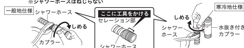
③ カプラーのキャップをはずし、スライダーを下に下ろしてから、本体のプラグヘカチッ音がするまで押し込みます。（スライダーがすでに下りている場合もあります。寒冷地仕様の場合はエルボが下向きになっていることを確認します。）
