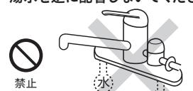
水を出そうとしても、湯が出てやけどをすることがあります。必ず給水配管が右側、給湯配管が左側に配管されていることを確かめてください。
