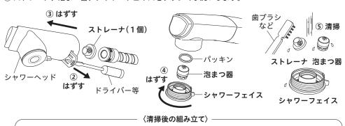
はずした逆の手順で組み立ててください。 その際、シャワーフェイスを締め込む時、約2回転程締め込んで、シャワーフェイスつまみ部が後ろで止まるまで締め込んでください。
