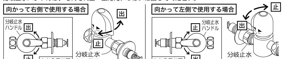
**△ 注意** 分岐止水ハンドルは無理な力を加えずゆっくり操作してください。急な操作や無理な力での操作はウォーターハンマー(水撃)音が発生し、配管からの漏水により家財などを濡らす財産損害発生のおそれがあります。
