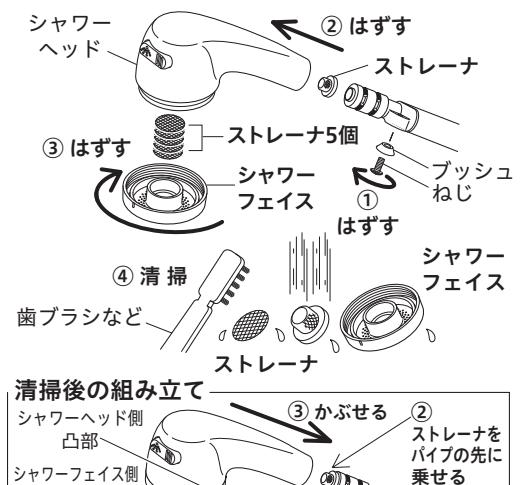
図の順に組み立ててください。シャワーフェイスを締め込む際、約3回転程締め込んで、シャワーフェイスの凸部とシャワーヘッド右側面の凸部を合わせてください。
