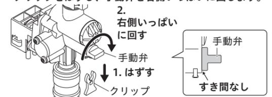
●復帰時(通常の状態) 手動弁を左側いっぱい回し、クリップを取り付けます。
