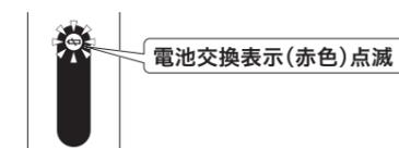
※電池交換表示が点滅後もそのまま使用続けると、表示が消灯し、センサーでの吐水・止水ができなくなります。(センサーに手をかざした時に警告音が鳴ります。)故障ではありませんので、乾電池を交換することで再度ご使用いただけます。
