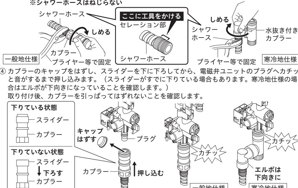
【△注意】シャワーhosseは止水栓に引っかけないで、給湯・給水パイプの間にぶら下げる取り付けてください。
