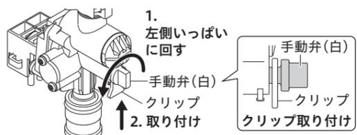
【△注意】高温の湯をお使いの後は手動弁(白)が熱くなっている場合があります。操作をする際は、やけどに注意してください。手動弁は工具を使わず手でゆっくりと操作し、無理に回しすぎないでください。
