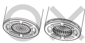
【お願い】止まるまで締め込んだら、それ以上締め込まないでください。破損するおそれがあります。締め付け不足の場合、漏水や切換不良の原因になります。
