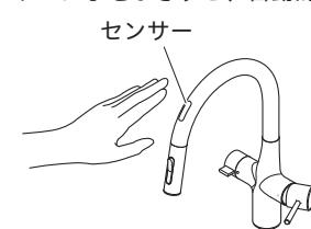
⑤ センサーまたはレバーハンドルを閉じて止水し、接続部からの水漏れがないことを確認してください。
