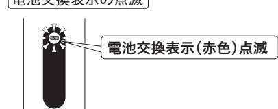
※電池交換表示が点滅後もそのまま使用を続けると、表示が消灯し、センサーでの吐水・止水ができなくなります。
