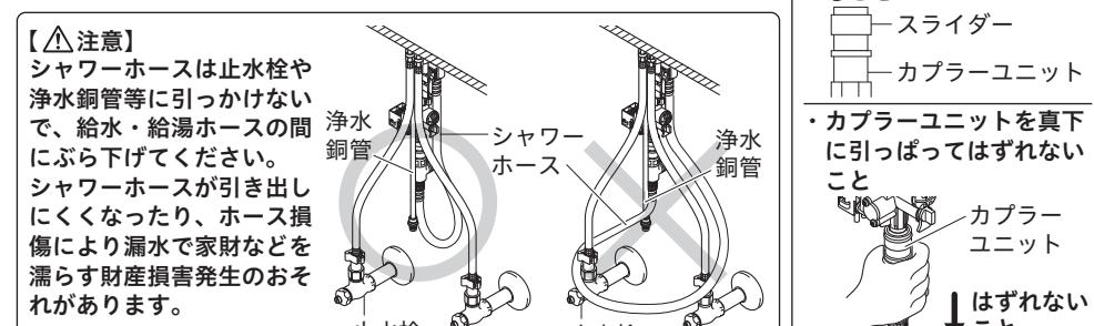
【△注意】カプラーユニット取り付け後、確実に接続されているか、以下の確認を行ってください。
