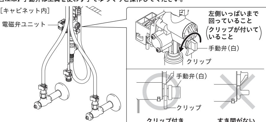
③ 湯水の止水弁を開き、混合栓レバーハンドルを吐水状態にします。
