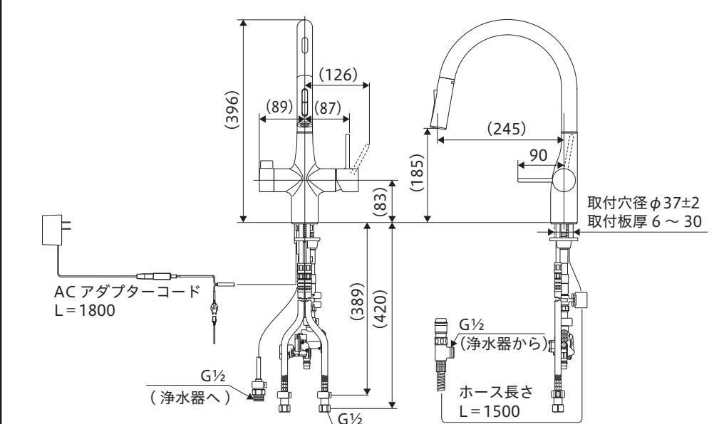
●水栓取付面からシンク下の底板(棚板)までの距離が575mm以上ないと、ホース収納時に底板(棚板)との干渉が大きくなり、使用上問題はありませんが、ホース収納性が悪くなります。
