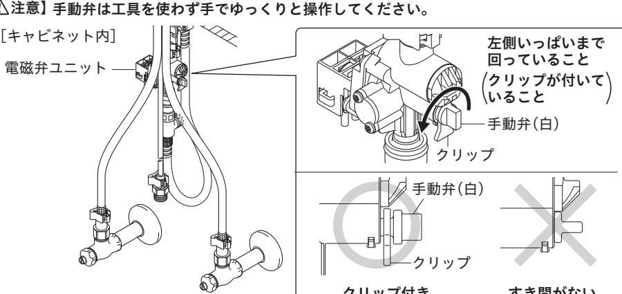
③ 湯水の止水弁を開き、混合栓レバーハンドルを吐水状態にします。
