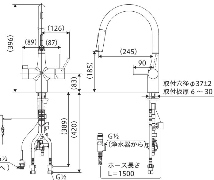
●水栓取付面からシンク下の底板(棚板)までの距離が575mm以上ないと、ホース収納時に底板(棚板)との干渉が大きくなり、使用上問題はありませんが、ホース収納性が悪くなります。
