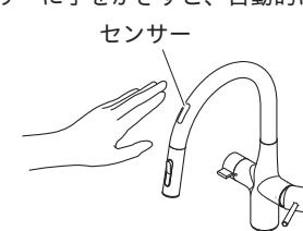
⑤ センサーまたはレバーハンドルを閉じて止水し、接続部からの水漏れがないことを確認してください。
