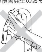
●吐水口がシンクより飛び出すような施工はしないでください。
