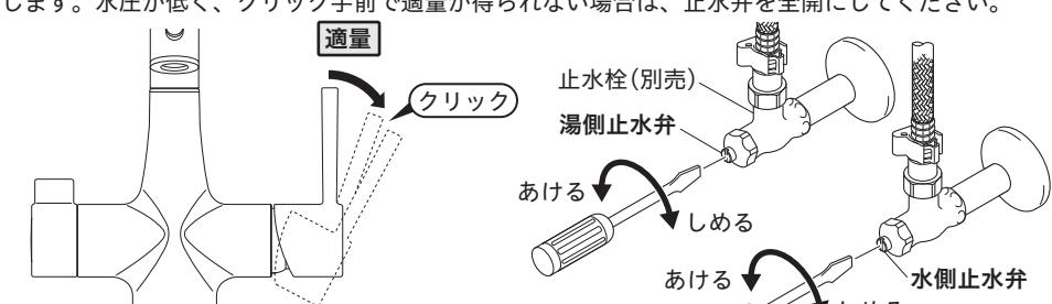
【△注意】すべての施工が完了した後、必ずレバーハンドルを閉じてください。
