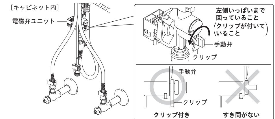
③ 湯水の止水弁を開き、レバーハンドルを吐水状態にします。
