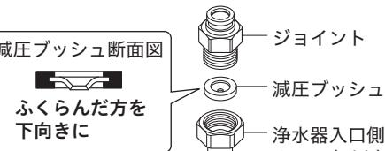
② ジョイントを浄水銅管にはめ込み、クイックファスナーを浄水銅管とジョイントのつばがすき間なく合うまで差し込んでください。
