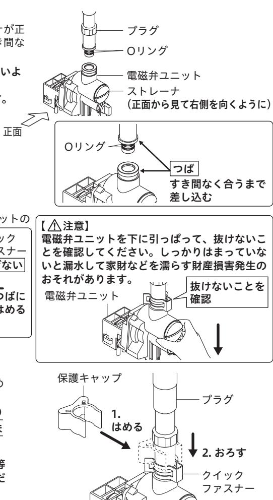
② クイックファスナーをプラグと電磁弁ユニットのつばにはめます。
