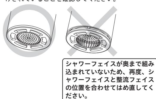
【お願い】止まるまで締め込んだら、それ以上締め込まないでください。破損するおそれがあります。締め付け不足の場合、漏水や切換不良の原因になります。
