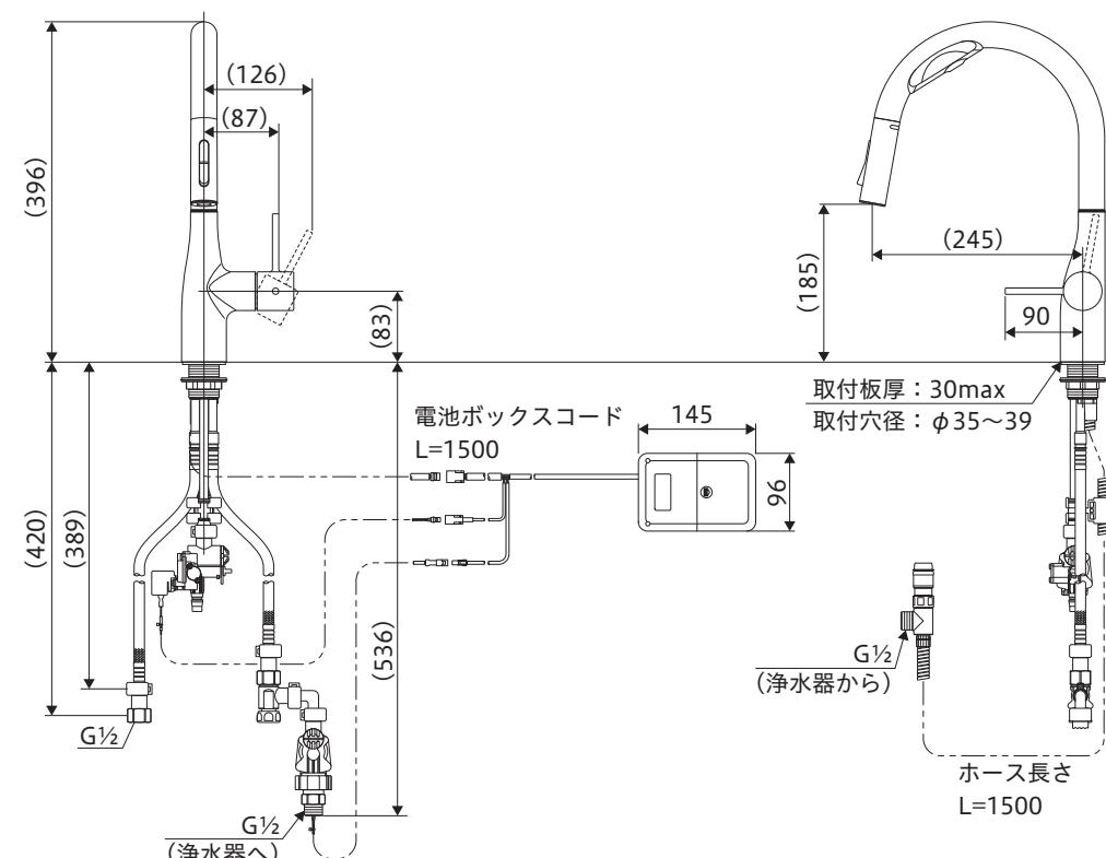
●水栓取付面からシンク下の底板(棚板)までの距離が575mm以上ないと、ホース収納時に底板(棚板)との干渉が大きくなり、使用上問題はありませんが、ホース収納性が悪くなります。
