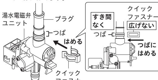
△ 注意 湯水電磁弁ユニットを下に引っ張って、抜けないことを確認してください。しっかりはまっていないと漏水して家財などを濡らす財産損害発生のおそれがあります。
