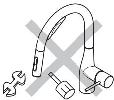
止水機構を持った市販浄水器具や止水機構を持った後付けの水栓ユニット等の取り付けはしないでください。
