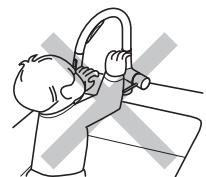
配管などの解氷のため、解氷機を使用する場合は、水栓(給水・給湯管含む)には絶対に通電しないでください。
