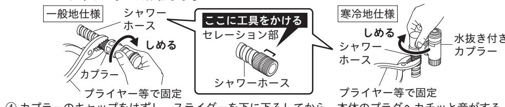
④ カプラーのキャップをはずし、スライダーを下に下ろしてから、本体のプラグヘカチッと音がするまで押し込みます。(スライダーがすでに下りている場合もあります。寒冷地仕様の場合はエルボが下向きになっていることを確認します。)
