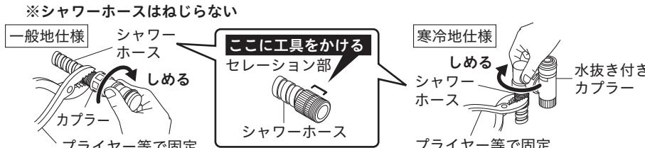
④ カプラーのキャップをはずし、スライダーを下に下ろしてから、本体のプラグへカチッと音がするまで押し込みます。(スライダーがすでに下りている場合もあります。寒冷地仕様の場合はエルボが下向きになっていることを確認します。)
